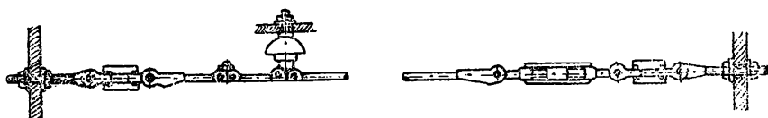
Fig. 9-10. Linie de contact cu conductoare rotunde fixate rigid.
