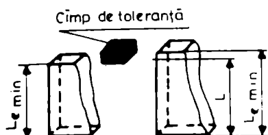
Fig. 2.4. Cepul — cîmpul de toleranță la lungime.
